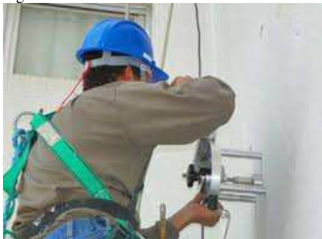
Figura 4 – Ensaio de Resistencia de Aderência a Tração
